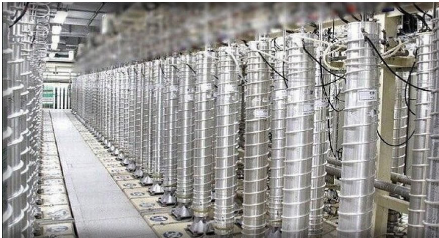
ภาพที่ ๒: เครื่องหมุนเหวี่ยง (Centrifuges) ในการเสริมสมรรถนะให้แร่ยูเรเนียม ณ โรงงานนิวเคลียร์นาทานซ์
