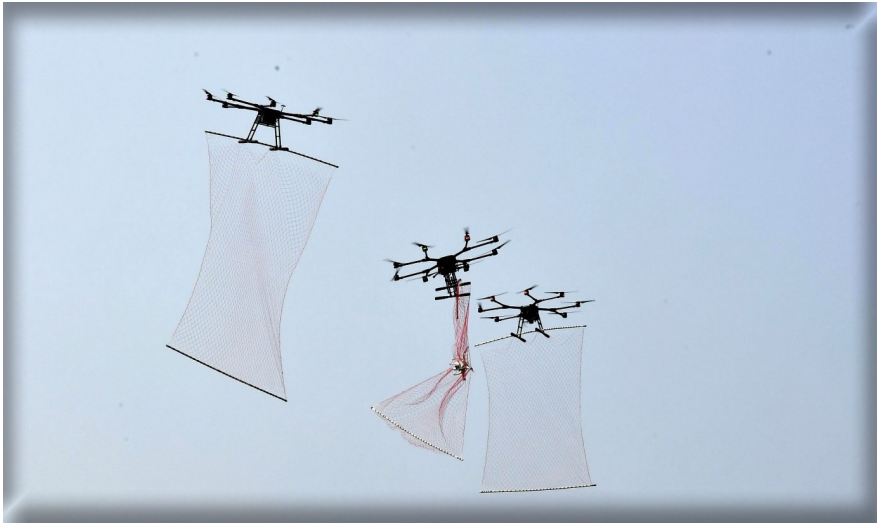
ภาพที่ ๑๐ อากาศยานไร้คนขับที่มีตาข่ายแบบห้อยเพื่อตักจับอากาศยานไร้คนขับอีกตัว (CNN, 2019)
