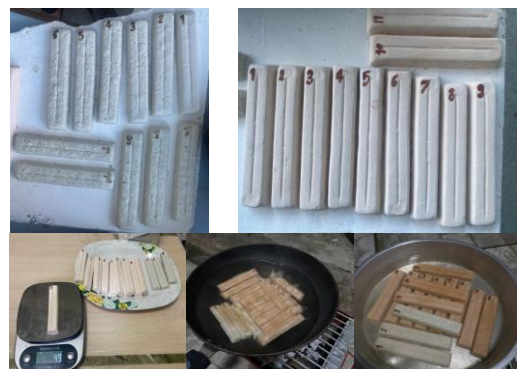
รูปที่ 3 ชิ้นงานที่เผาเสร็จแล้วในแต่ละสูตร
