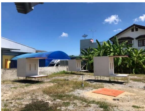
รูปที่ 15 ตำแหน่งการวางบ้านทดสอบเพื่อไม่ให้บังเงากัน
