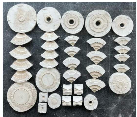
รูปที่ 12 แม่พิมพ์ปูนปลาสเตอร์สำหรับหล่อน้ำดิน
