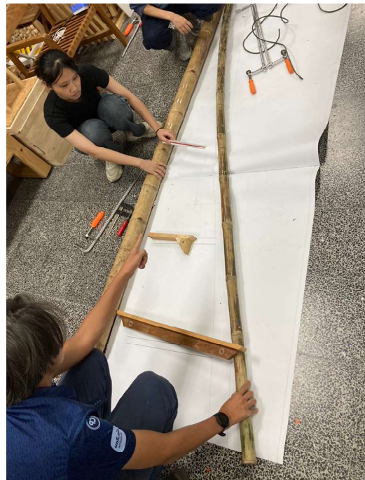
รูปที่ 5 ทดลองการตัดโค้งด้วยการบากไม้ไผ่
