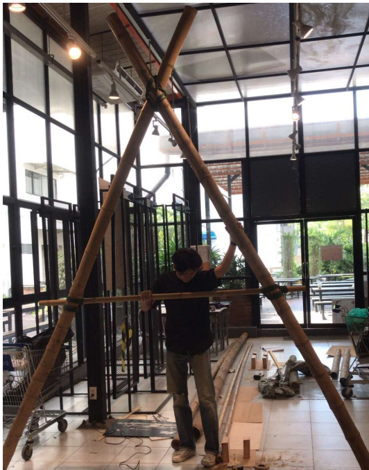
รูปที่ 7 ทดสอบขาตั้งรับน้ำหนัก
