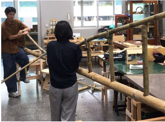
รูปที่ 6 ทดสอบการทำโครงถักไม้ไผ่ช่วงพาดกว้างลักษณะโค้ง
