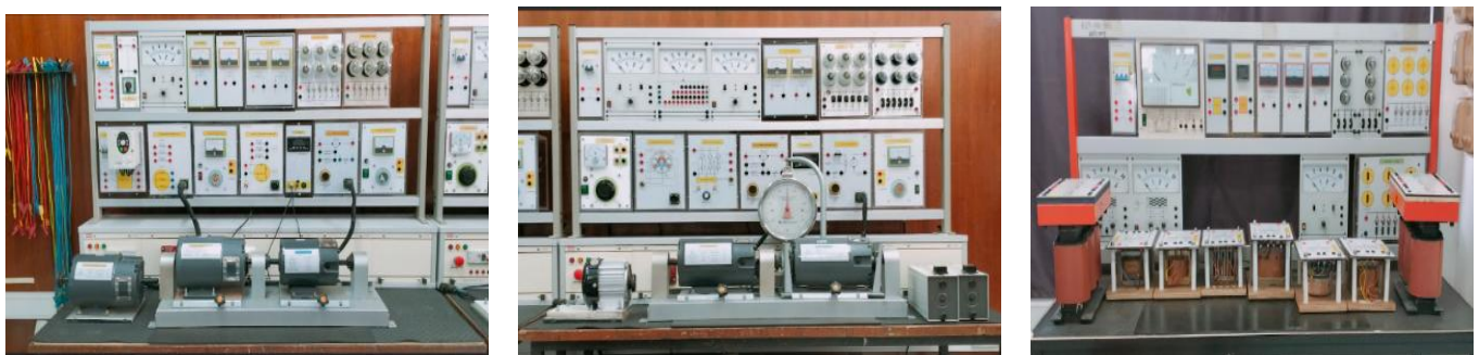
(ก) แผงฝึก EM 09 เครื่องกำเนิดไฟฟ้ากระแสตรง (ข) แผงฝึก EM 10 มอเตอร์ไฟฟ้ากระแสตรง (ค) แผงฝึก EM 09 หม้อแปลงไฟฟ้า
